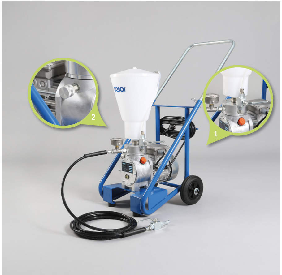
1. Conduite de retour avec soupape à bille
