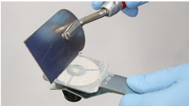
Kleber (Sikadur®-31+) auftragen
