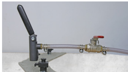
DESOI Z-Slider auf den Flachkopfnippel schieben
