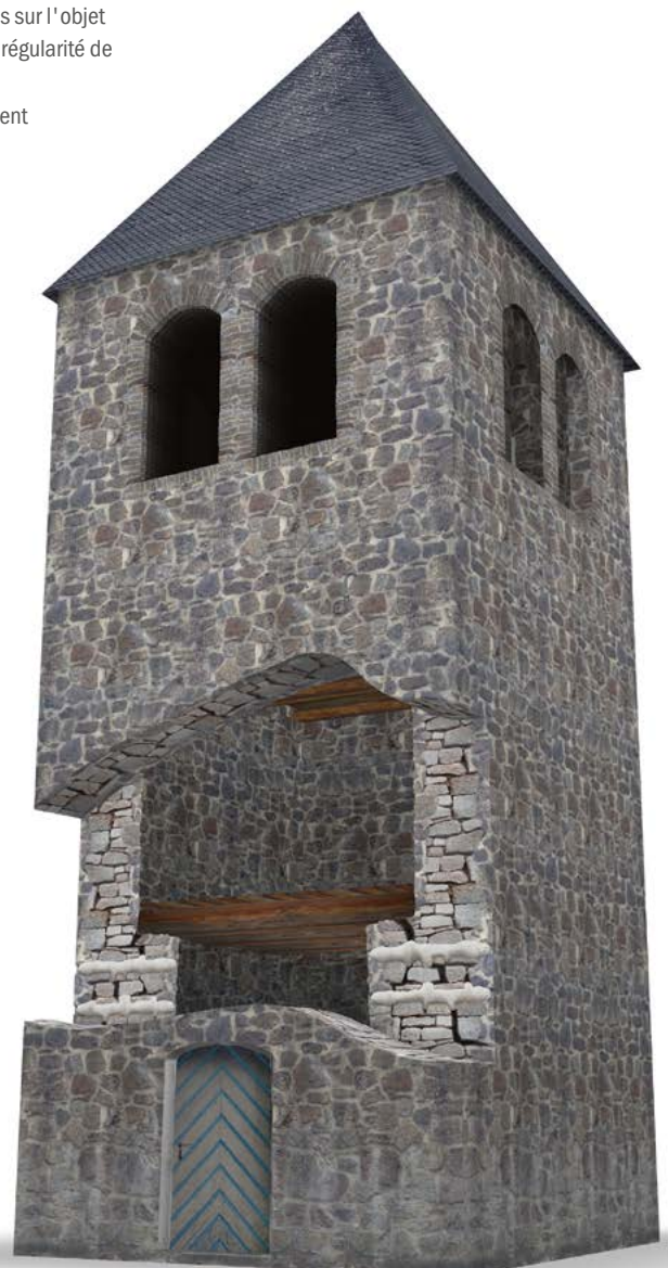
Verbindung abgelöster Mauerwerkschalen Raccordement des murs séparés
