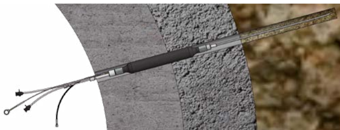
Gespannter Blähpacker mit Entlüftung vor der Injektion Injecteur gonflable étiré avec ventilation avant l'injection
