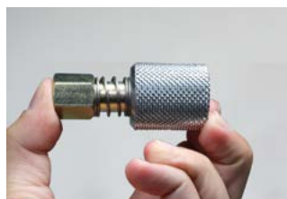
Sicherung gegen die Druckfeder zurückdrücken Repousser le dispositif de sécurité contre le ressort de pression
