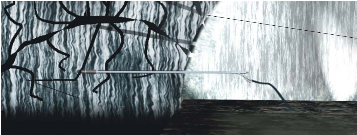
Spannpacker positionieren und mit der Spann- und Injektionsvorrichtung verspannen | Installer l'injecteur de fixation en utilisant le dispositif de fixation et d'injection
