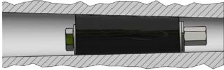
Blindpacker gespannt im konischen Bohrloch Vanne pour forage serré dans un trou de perçage conique
