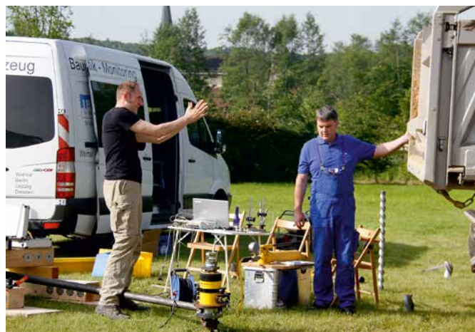
Pfahlprobelastung im Versuchsfeld | Charge d'essai sur pieux dans le champ d'essai
